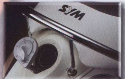
Praktisch: Tankdeckel durch Fernentriegelung
